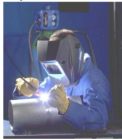
Obrázek 1. WIG svařování korozivzdorných ocelí pomocí ochranné atmosféry Arcal™ dodané v tlakové lahvi se sdruženým lahvovým a redukčním ventilem Altos™
