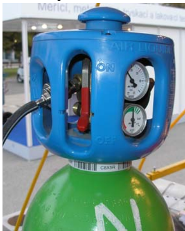
Obrázek 1. WIG svařování korozivzdorných ocelí pomocí ochranné atmosféry Arcal™ dodané v tlakové lahvi se sdruženým lahvovým a redukčním ventilem Altos™
