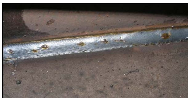
Obr. 10. Ochranný plyn: Ar/CO 2 – M21 Průtok: 13 l/min Svařovací proud: 260 – 320 A Napětí: 27 – 32 V
