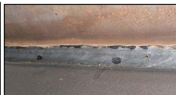
Obr. 12. Ochranný plyn: Arcal 24 Průtok: 13 l/min Svařovací proud: 260 – 320 A Napětí: 27 – 32 V
