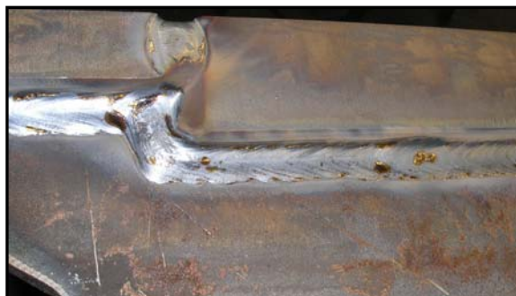
Obr. 11. Ochranný plyn: Arcal 24 Průtok: 13 l/min Svařovací proud: 260 – 320 A Napětí: 27 – 32 V
