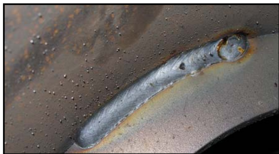
Obr. 9. Ochranný plyn: Ar/CO 2 – M21 Průtok: 13 l/min Svařovací proud: 260 – 320 A Napětí: 27 – 32 V
